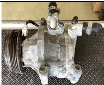
写真1 エアコン・コンプレッサ
